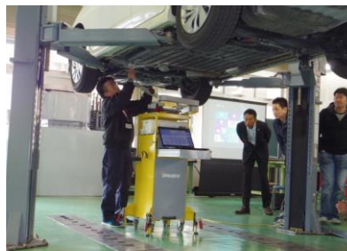
三次元計測の作業中 (MSジャパン)
