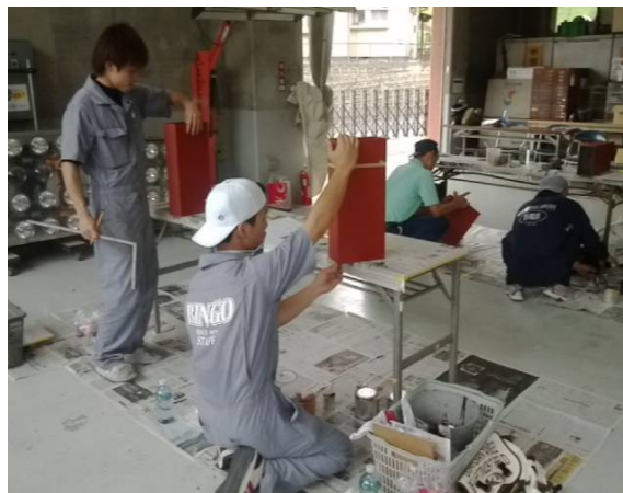
塗装する場所を測っています。 その後マスキングします。
