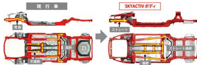
図1 基本骨格のストレート化、連続化技術
