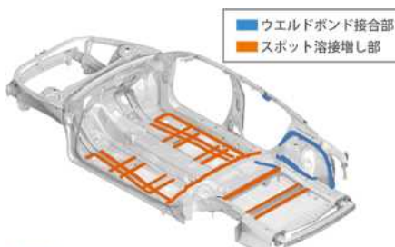
図6 ウエルドボンド、スポット溶接増し
